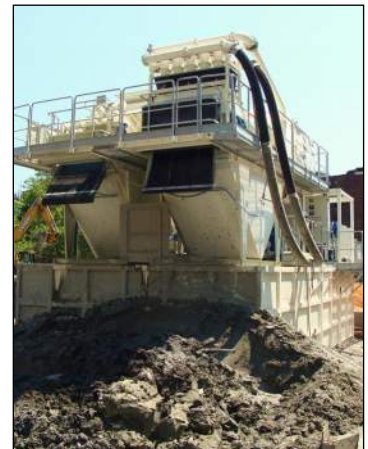
Sotres Desanding Unit
